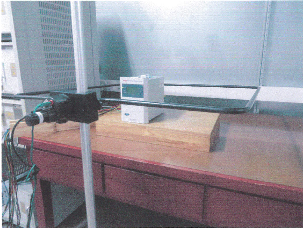
图 9: 工频磁场抗扰度检验配置图
