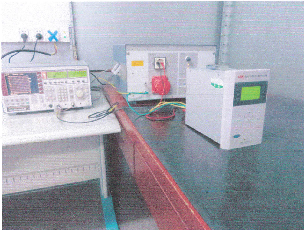
图 2: 传导发射限值检验配置图
