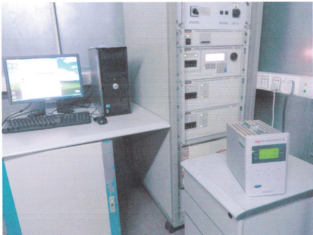
图 12: 辅助电源端口电压暂降、短时中断、电压变化和纹波检验配置图
