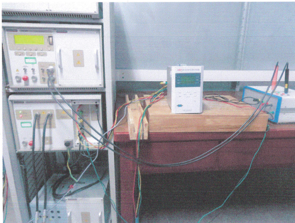
图 8: 浪涌抗扰度检验配置图
