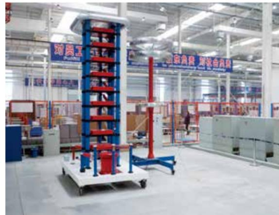
冲击试验系统，电压等级 $\pm 900\text{kv}$ ，标准雷电冲击电压全波，时间精度： $1.2 \pm 15\% \mu\text{s} / 50 \pm 10\% \mu\text{s}$ ，幅值精度： $\pm 2\%$ ，冲击电压波形符合GB311、GB16927-2标准要求
