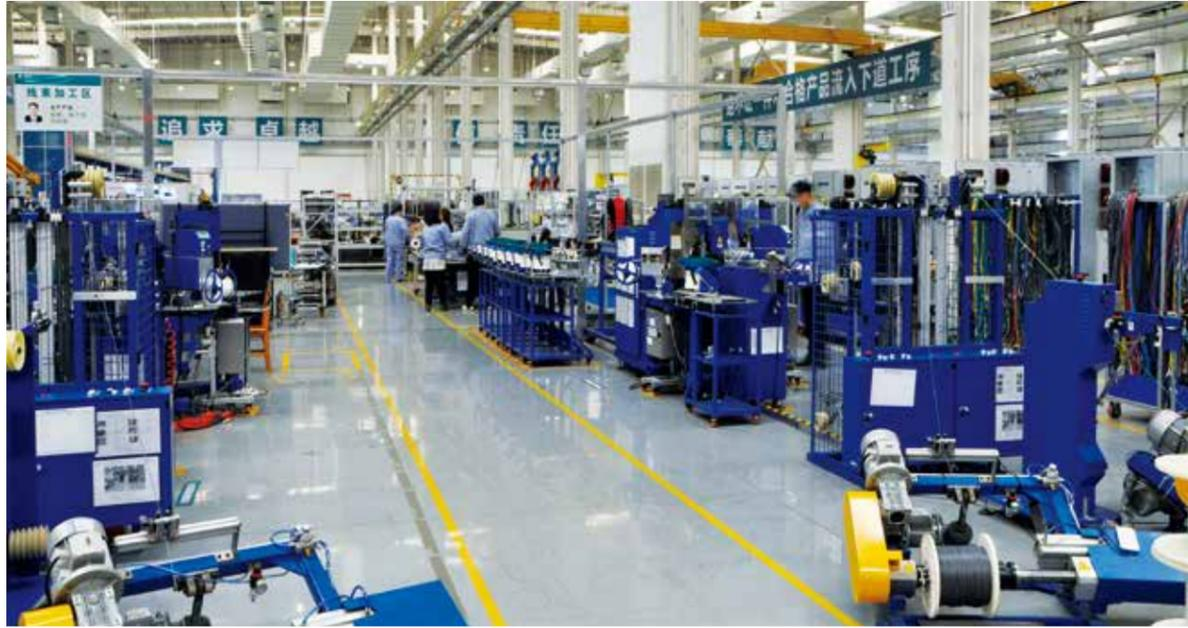
自动线束加工设备，实现了二次导线下线、打号牌、串号牌、穿端头、压端头等所有线束加工流程自动化，解决了困扰开关设备制造行业因员工技能差异造成的线材加工质量不稳定的问题，真正实现了产品品质内置。
