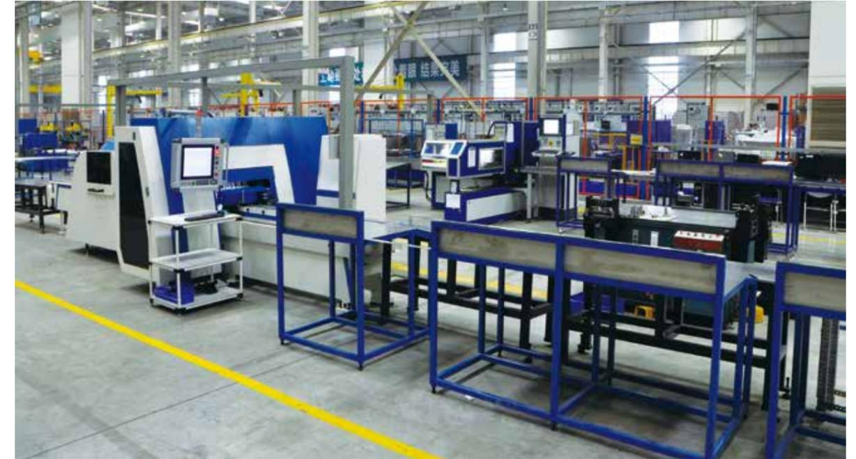
德国EHRT母排加工设备，配备电子角度测量系统，测量精度为0.1度；具有折弯自动弹性补偿功能，加工精度高；冲孔频率最高可达120次/分，生产效率高。
