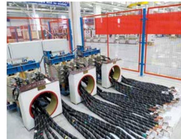
大电流温升试验系统，额定电流15000 A，端口电压10 V
