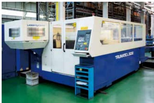
德国通快 TRUMPF 公司 L3030 型激光切割机，在 1.5m×3m 的平面的任何位置上其切割精度误差为 0.06 mm
