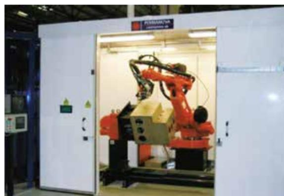
瑞典 PermanaRofin DY3300 公司 YAG 激光焊接机，保持焊接零件在立体位置变换时焊缝轨迹的偏移度小于 1 mm
