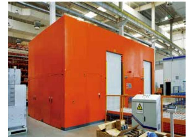
全自动氦检漏系统，年漏气率检测降低小于0.1%，可100%避免人工操作带来的漏检问题
