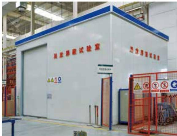
局放测量及工频试验系统，系统电压200 kV，全天候背景噪音 $\leq 0.3\text{pc}$ ，配备德国PDSG公司的高精度ICMcompact局部放电检测仪
