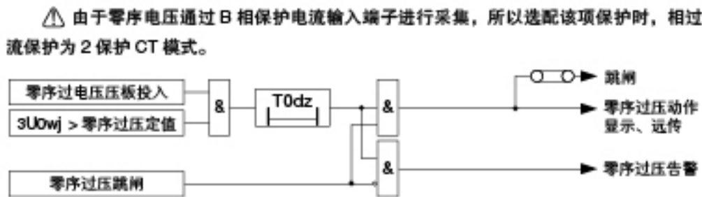
图 3-22 零序过压保护原理框图
