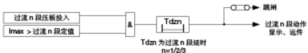
图 3-6 过流保护原理框图
