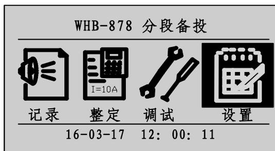
按“确认”键输入正确密码后进入设置菜单，按△、▽键移动光标选择要设置的对象。本菜单共包含如下对象单元：“通讯设置”、“修改时钟”、“修改密码”、“参数设置”、“自检设置”。选定某一项菜单后按“确认”键即可进入对应的设置对象。对某项数据修改完后按“退出”键装置会提示是否保存您对装置的修改，相应的选择“取消”或“确认”即可。
