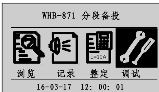
进入调试菜单，通过按△、▽键选择“模拟量校准”、“出口传动”、“通信对点”选项。按“确认”键，输入正确密码后进入所选项。
