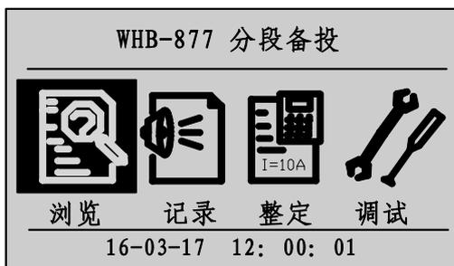
在主菜单下按◀、▶选择“浏览”，按“确认”键进入“浏览”菜单，进入后按△、▽键移动光标选择要浏览的装置数据。本菜单共包含如下数据单元：“保护数据”、“开关量”、“压板状态”、“定值数据”。选定某一项数据单元后按“确认”键即可进入并查看看到相关的数据。
