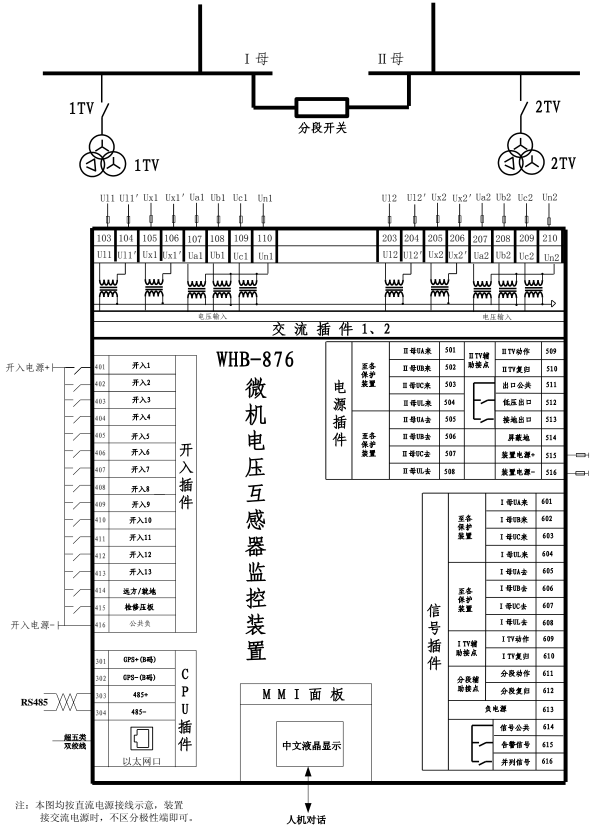
附图 9.2 装置典型接线示意图
